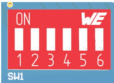
Obr. 14. DIP přepínače pro výběr chování servopohonu během selhání ovládacího signálu
